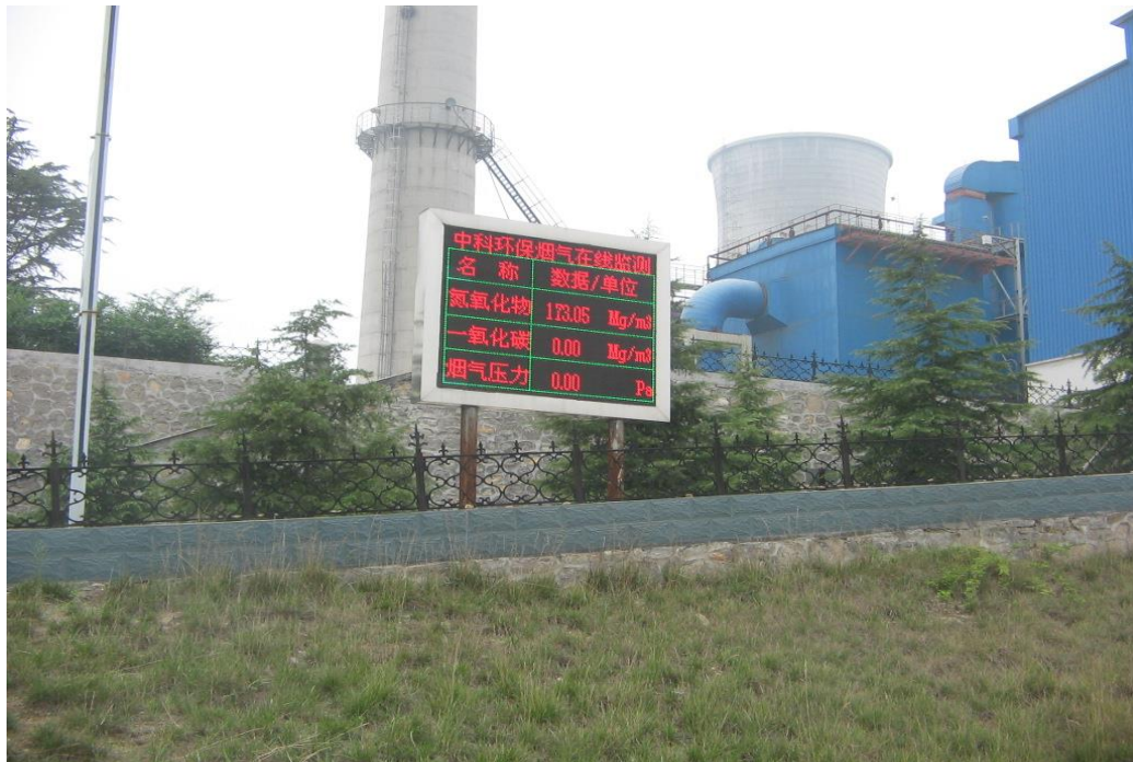
รูปที่ ๑๔ ป้ายแสดงภาวะคุณภาพอากาศที่ปล่อยออกจากปล่องระบายอากาศ
