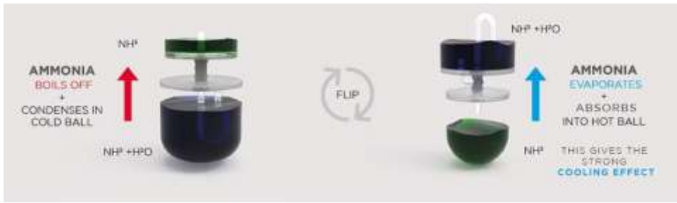
ภาพแสดงการทำงานของกระบวนการเคมีภายในผลิตภัณฑ์ ไอโซบาร์
