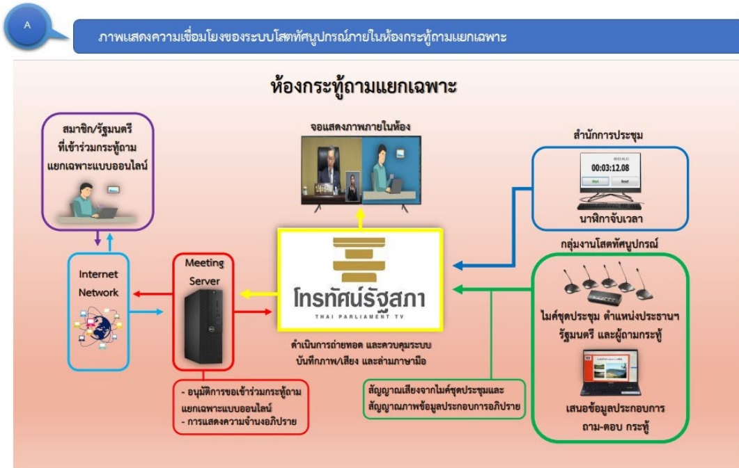
ภาพที่ ๑๐ แสดงความเชื่อมโยงของระบบโสตทัศนูปกรณ์ภายในห้องประชุมแยกเฉพาะ
