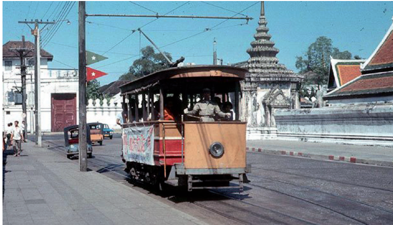
ป้ายสามเหลี่ยมสีแดงมีดาวตรงกลางคือจุดจอด ขึ้นลงและรับผู้โดยสาร....ส่วนป้ายสามเหลี่ยมสีเขียวมีดาวตรงกลางคือป้ายแสดงจุดให้รถรางรอหลักขบวนกัน
